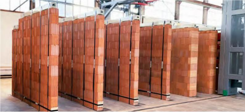
Die Ziegel-Wandelemente werden nach der Fertigung getrocknet und erst nach einer Qualitätsprüfung für die nächsten Schritte freigegeben.
