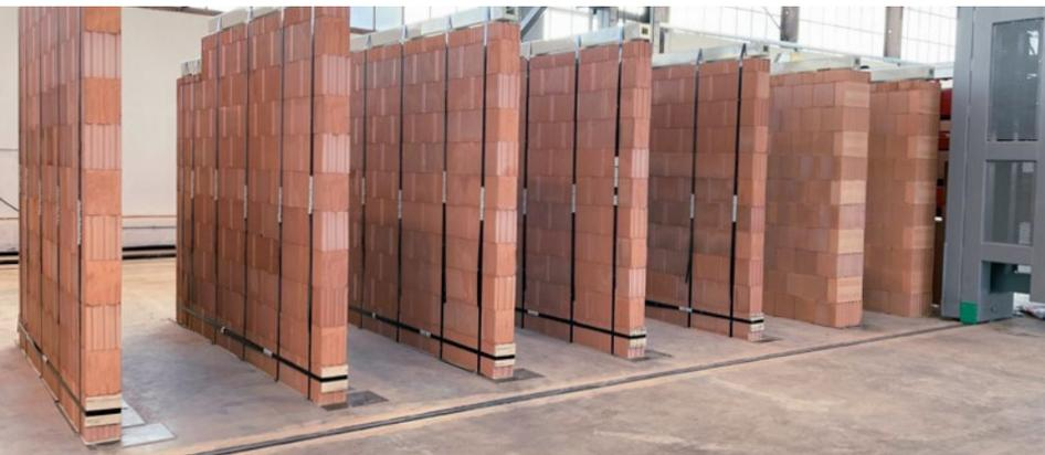
Die ZIEGEL-Wandelemente werden nach der Fertigung getrocknet und erst nach einer Qualitätsprüfung für die nächsten Schritte freigegeben.
